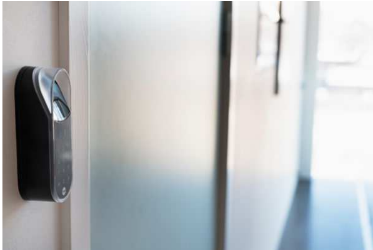
Varje lägenhet på HSB Living Lab har fått ett digitalt lås. Hyresgästerna kan själva välja om man ska kunna öppna med en sifferkod eller med ett fingeravtryck. Bild: Julia Sjöberg
